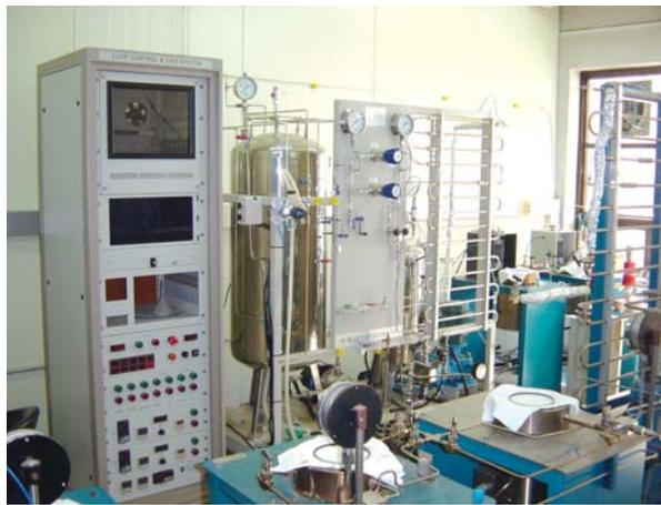
그림 3. PWSCC test loop
