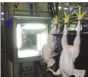
〈그림 1〉 도계장에서 VQIS를 통한 도체 사진촬영 모습
