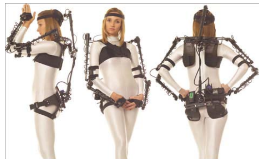
(그림 5) 기계식 모션캡처시스템
