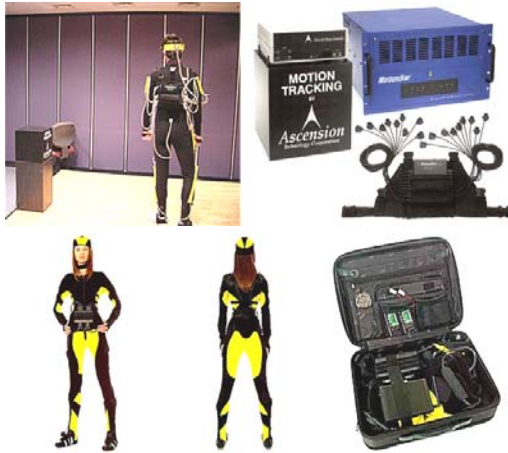
(그림 6) 자기식 모션캡처시스템
