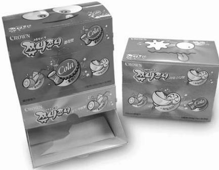
기존 전면부를 개봉하는 진열 상자의 경우 개봉부를 형성하기 위해 별도의 재료를 사용하거나 작업자가 직접 끼워 넣어야 하는 불편함이 있었다. 상자를 밀봉하기위해 테이프나 기타 잠금장치를 사용함으로 인해 제조단가 상승 및 생산성이 저하되는 문제가 제기되어 이를 개선하고자 기존 3면 접착 케이스를 응용하여 상자를 제작하였다. 전면부에 대한 별도의 작업 없이 작업자가 작업공정을 수행할 수 있다. 또한 자동으로 제품을 투입할 수 있는 생산 시스템으로 확장 할 수 있으며 전면부에 별도의 잠금 장치가 필요 없어 제조단가 절감 및 생산성을 향상시킬 수 있다.
