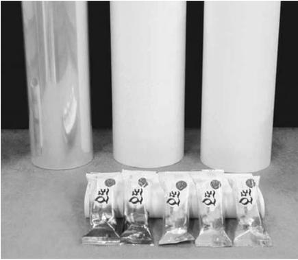
나노필름은 Gas차단성을 필요로하는 제품에 적용하기 적합한 재료이다. 코팅제를 수성화 하여 혁신을 이루었고, Gas 차단성을 향상 시킨 기능성, 재고관리가 용이한 경제성, 유기용제 배출 Zero로 환경친화성을 가진 것이 특징이다. Film 고유의 물성을 유지시키므로써 어떠한 필름보다도 적용하기 용이한 기능성 포장 재료이다.
