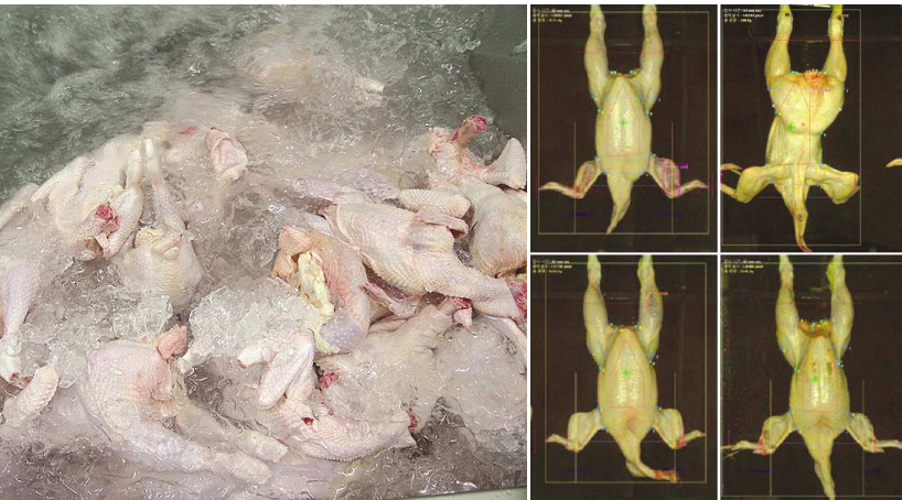
아이스 워터칠링 냉각기법이 육심온도를 5°C 이하로 낮춘다. VQIS(품질체크시스템)
