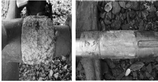
Fig. 14 축에 부착된 양극 형상 및 양극이 부착되었던 축 표면
