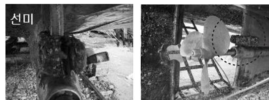
Fig. 16 AMF type(직사각형 형태)의 양극이 부착된 선체의 형상
