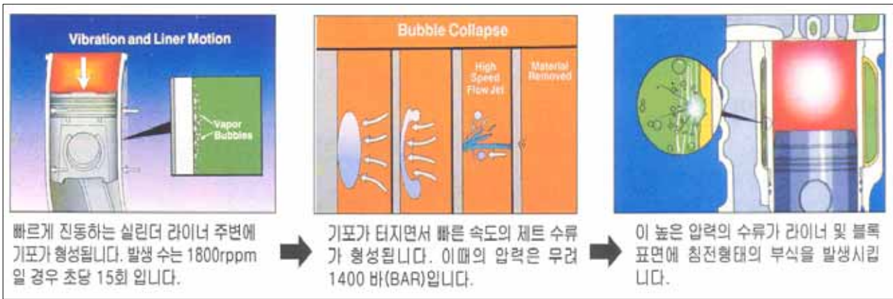
[그림 17] 냉각수계통의 피팅형 부식 진행과정
