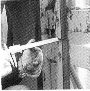
〈그림 1〉 랙기어 연결부 어긋남 측정
