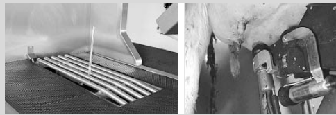
착유종료 후 소독 착유 후 유두별 개별탈락 그림12. 착유컵은 유두별로 개별 탈락되고 착유종료 후 착유틀이 열리면서 젖소가 나감
