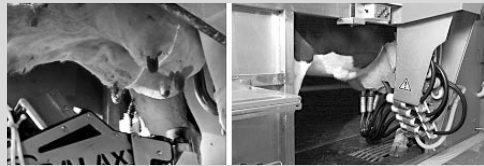
센서를 이용 유두감지 유두에 유닛 부착 그림11. 유두위치와 형태를 감지하고 착유컵 부착
