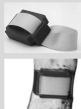
그림7. 발정감지기(발목걸이형): 24시간 감시 및 개체식별 기능
