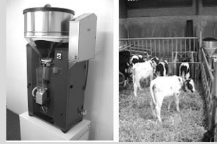
그림8. 송아지포유기: 개체별 급이량 조절을 통해 폐사율의 감소 및 약품투여 용이
