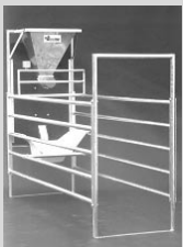
그림5. 사료자동 급이기: 최대 4가지의 사료를 동시 급여 가능하며 관리용 프로그램과 연결되어 급이 조정
