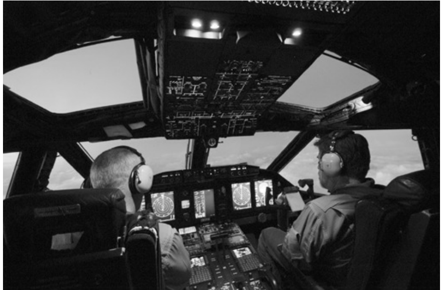
C-27J에는 2개의 전방시현기(HUD)와 디지털 무빙 맵을 비롯한 비행정보를 보여주는 5개의 다기능 시현기가 설치됐다.
