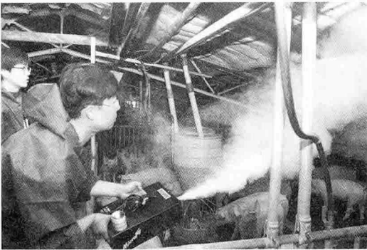
▲ 유속 및 환기량을 직접 눈으로 보기 위한 스모그 제네레이터
