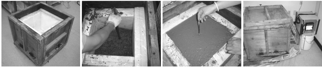
[사진 1] 콘크리트 간이단열온도 시험
