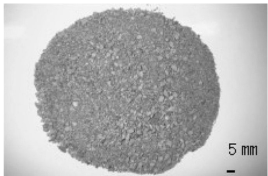
기계식 마모장치를 이용한 재생 굵은골재 및 재생잔골재
