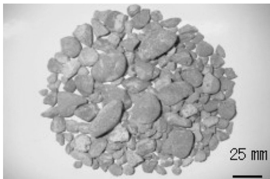
기계식 마모장치를 이용한 재생 굵은골재 및 재생잔골재
