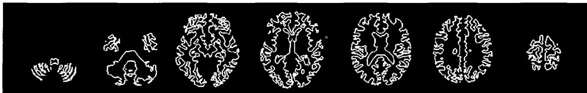
그림 3. 라플라시안 검출기로 추출된 외곽선. Fig. 3. Results of the Laplacian of Gaussian edge detector.
