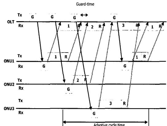
그림 3. Adaptive cycle time으로 동작하는 E-PON
