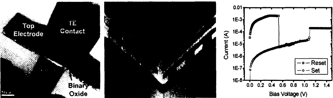
〈그림 R3〉 삼성전자의 filament 저항메모리 구조와 스위칭 I-V curve
