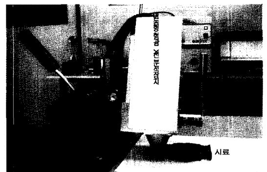
사진 6. 이동형 형광 X-선 분석에 의한 콘크리트 시편의 측정
