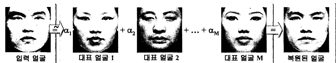
그림 2 예제 기반 얼굴 복원의 기본 개념: 임의의 입력 얼굴은 대표 얼굴의 선형 가중합으로 근사화 시킬 수 있다.
