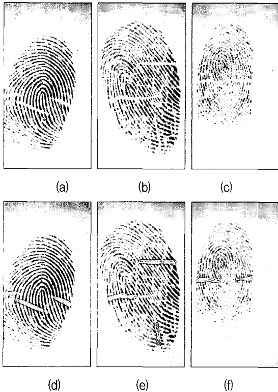
그림 9. 다양한 영상에 대한 주름선 검출 결과 (a, b, c) 입력 지문 영상 (d, e, f) 주름선 영역 검출 결과 영상 Fig. 9. Crease detection of several fingerprint images. (a, b, c) Original fingerprint images (d, e, f) Results of crease detection
