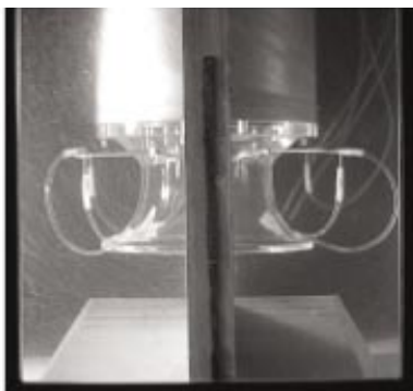
[그림 5] Installed pitot-tubes
