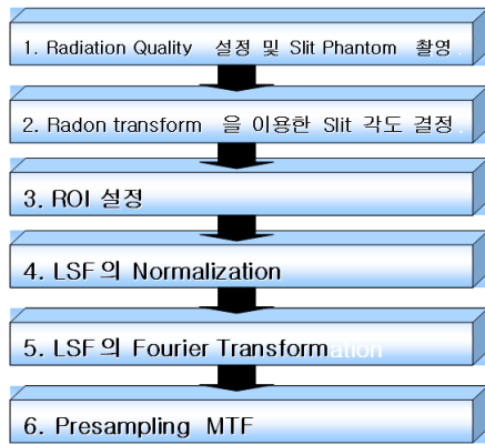
그림5. Presampling MTF를 측정하기 위한 과정
