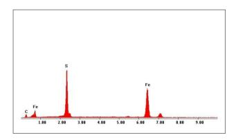
Fig. 10. Scale EDX Spectrum
