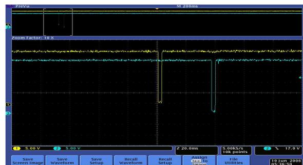
그림 7. ACQ\_START와 ACQ\_END 신호의 발생
