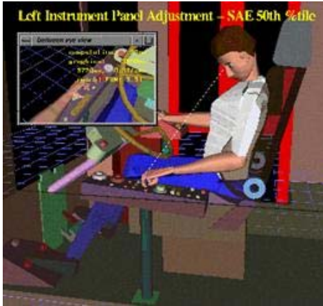
그림 1. SAE 50%ile 인체모형을 이용한 버스 운전공간 평가
