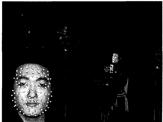
그림 1. 광학식 모션 캡처 시스템을 사용한 얼굴 모션 캡처 장면 및 배우의 얼굴에 부착한 마커 100개 부착위치
