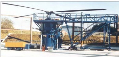
자료 : 독일 ZFL사 헬타워 소개자료, 2006년도 그림 4. 연구개발용(오토번) 헬타워 설비 전경
