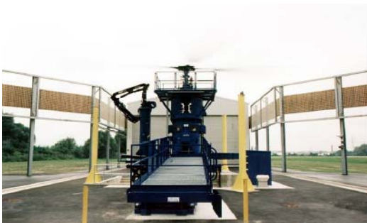
자료 : 독일 ZFL사 헬타워 소개자료, 2006년도 그림 3. Tiger 헬리콥터용 헬타워 설비 전경
