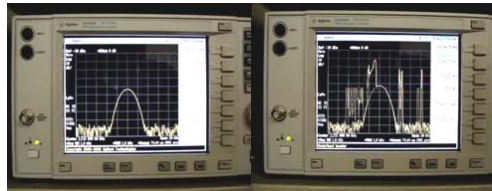
그림 14. Measured phase nulling spectrum in CW mode(왼쪽: 42.5 dBm, 오른쪽: 43 dBm)
