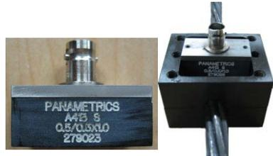
Fig. 8 초음파 시험에 이용된 탐촉자 및 부착된 구성
