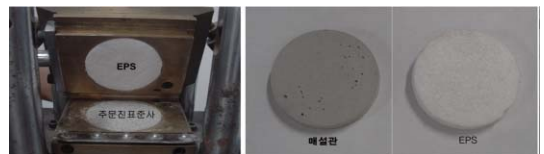
Fig. 3 직접전단시험기를 이용한 마찰시험
