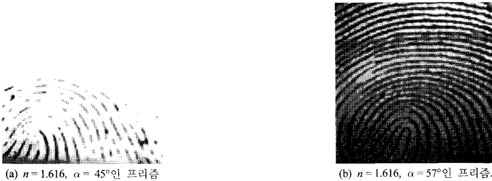
그림 6. 직각프리즘과 제안된 방식으로 제작된 프리즘을 사용한 광학계의 지문 영상 비교.
