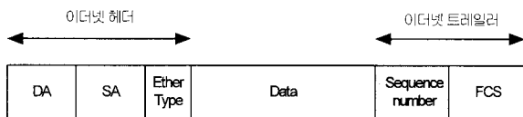
그림 6. 링크계층 순서 번호가 삽입된 이더넷 프레임의 구성
