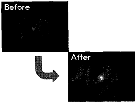
그림 5. 단일모드 광섬유의 열처리 전과 후. Fig. 5. Single-mode fiber of before and after the heat treatment.
