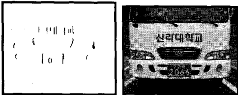
③ 잡음 제거 ④ 최종 영역 검출 그림 2. 번호판 영역 추출 과정
