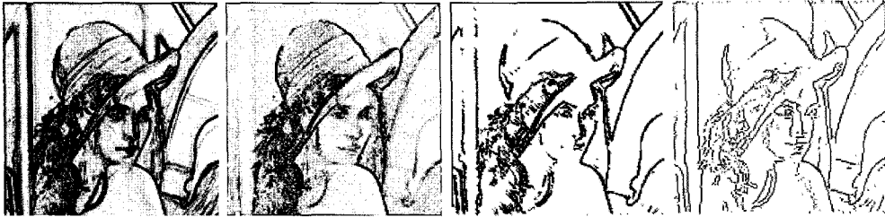
(a) Sobel (b) Laplacian (c) Canny (d) Proposal
