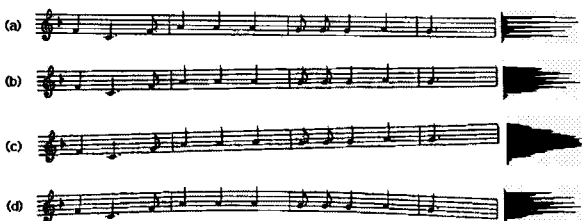
그림 5. 왜곡된 영상의 수평방향 히스토그램: (a) 원본 영상, (b) 1°기울어진 영상, (c) 2°기울어진 영상, (d) 휘어진 영상
