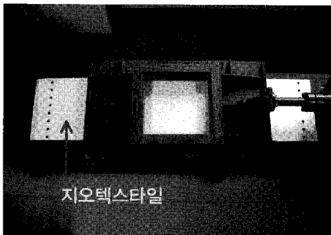
그림 5. 전단시험기에 고정된 지오텍스타일
