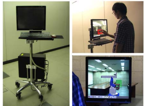
그림 3. 제조 공정의 공정 배치를 위한 혼합 현실 인터페이스 프로토타입 MIRAGE: (좌) 시스템 하드웨어, (우상) 상호작용 예, (우하) 포장을 위한 로봇의 배치 예
