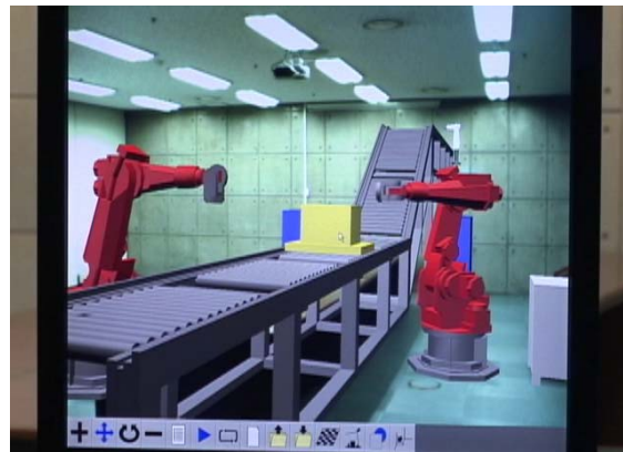
그림 5. 제안된 프로토타입에서의 공정 시뮬레이션: DELMIA의 시뮬레이션 결과와 포장 로봇의 제어코드를 활용하여 제안된 인터페이스에서 배치 결과를 확인
