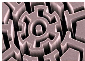
그림 3. DRIE에 의한 모터의 로터가공 예
