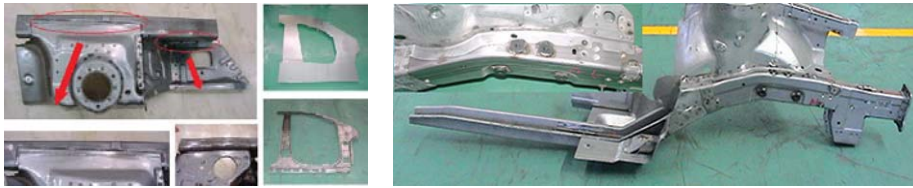
그림 7. 레이저 용접을 적용한 차체 부품
