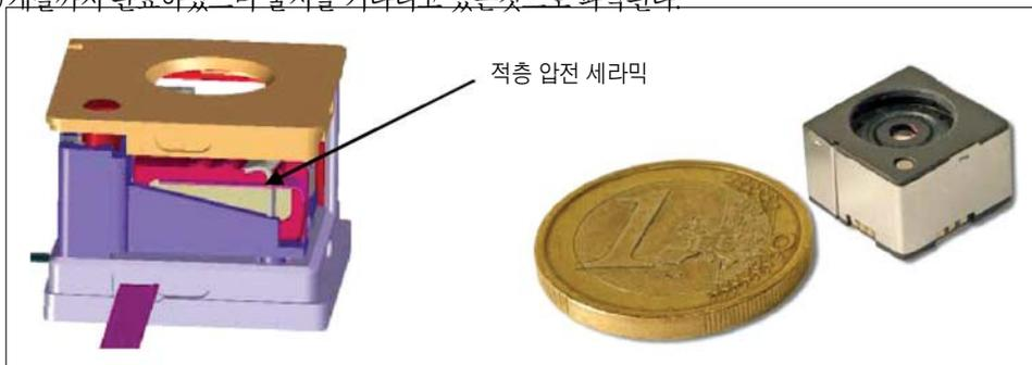
그림 17. Johnson Nanomotion사의 Nano Lens AF 카메라 모듈<sup>[9]</sup>
