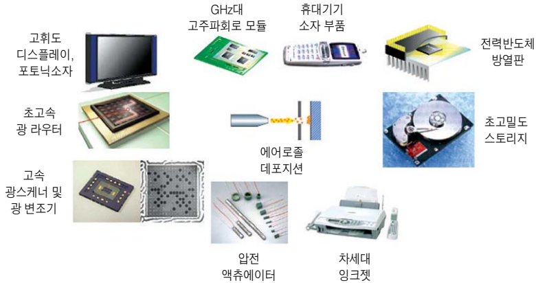
그림 10. 에어로졸 대포지션 공정이 적용되는 전자 부품 8) .
