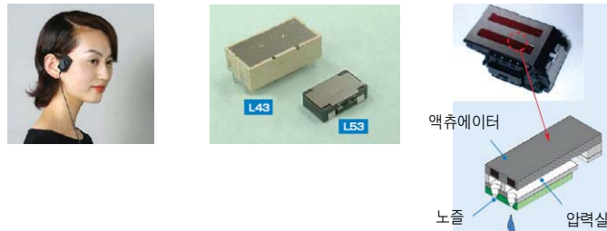
그림 11. 에어로졸 데포지션에 의해 제작된 압전 후막 코팅 소자들의 적용분야 10) ; (a) 골전도 스피커, (b) 손 떨림 보정 자이로, (c) 잉크젯 프린터 헤드.
