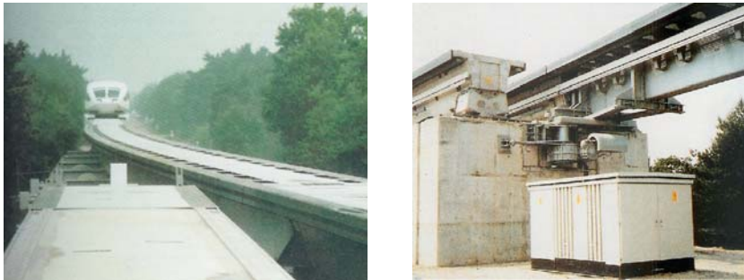
그림 3. 남쪽루프에 설치된 분기구간과 북쪽루프에 설치된 전기기계적인 구동장치
