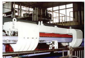
그림 6. 전자석, 브레이크 shoe 의 교체가 용이한 pole 일체식 대차
