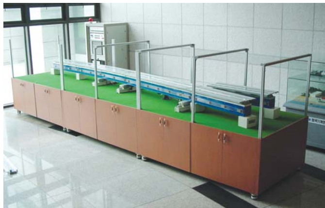
그림 10. 1/7 scale 모델 굴절형 자기부상열차 분기기
