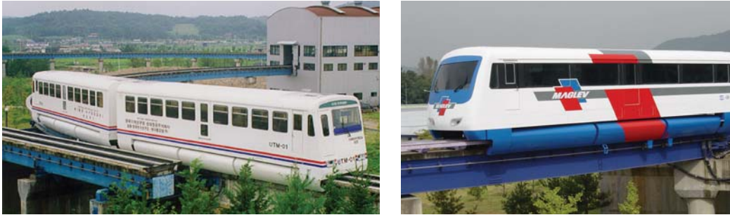
그림 3. 기계연구원 시험선로에서 주행성능시험중인 UTM-01
