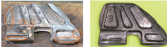
그림 14. Ti-6Al-4V합금 날개형상의 최적화 설계 전 · 후의 날개성형품 형상 비교
