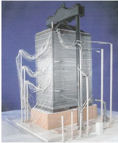
그림 6. 독일 울리히 연구소의 5kW급 평판형 SOFC 스택
