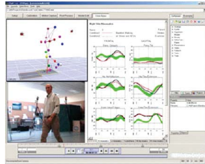
그림 3. Motion Analysis© 사의 모션캡처 시스템을 이용한 보행분석의 예
