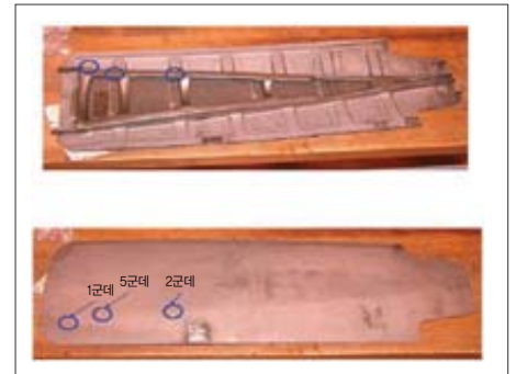
Nozzle Flap Crack 현상 2
