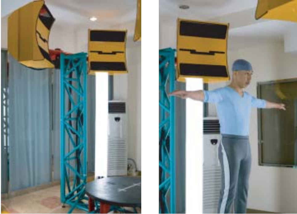
사진 2. 산업자원부 기술표준원 생활표준연구소의 Whole body 3D Scanner(좌)와 전신 스캔을 실시하고 있는 모습(우)
