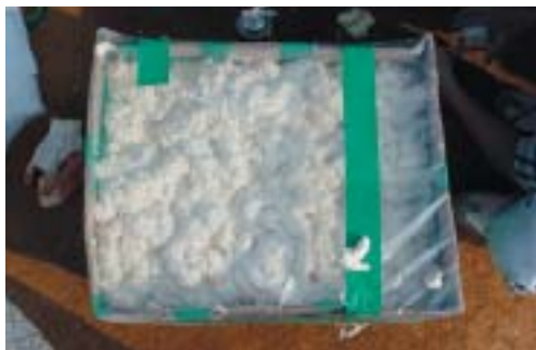
사진 21. 하단부 우레탄폼 충전
