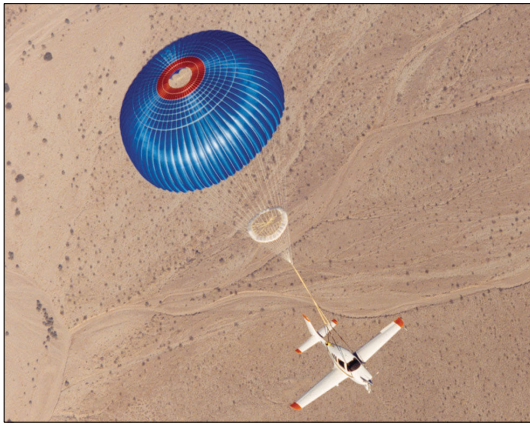
그림 9. Cirrus SR 22 항공기에 장착된 BRS Chute
